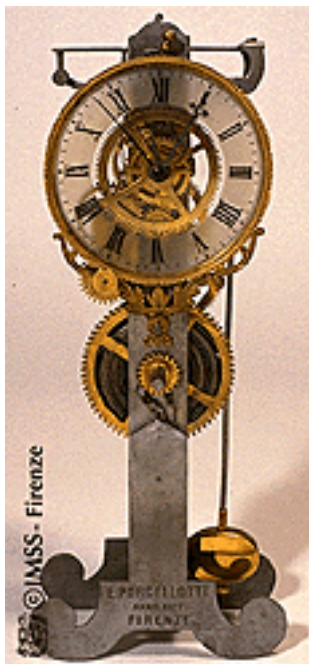
1. ábra Galilei vázlata alapján épített ingás óra 2
